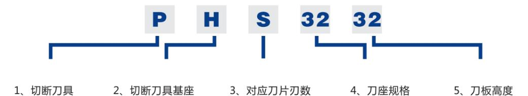
外圆切断、切槽刀具
